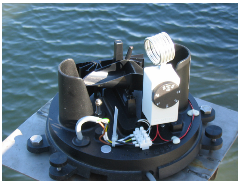
Figur 2-1 Vippmekanismen (dubbelvippa) i en vanlig typ av nederbördsgivare (Casella, 0.2 mm). Foto: Claes Hernebring.
