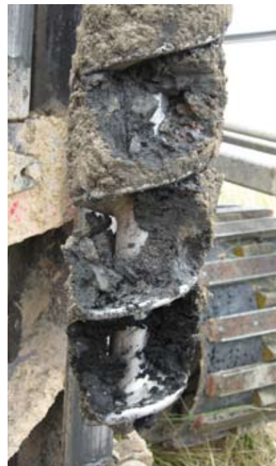
Figur 2-12 Prov från tätskiktet taget med skruvborr, Gärstad juni 2008.
