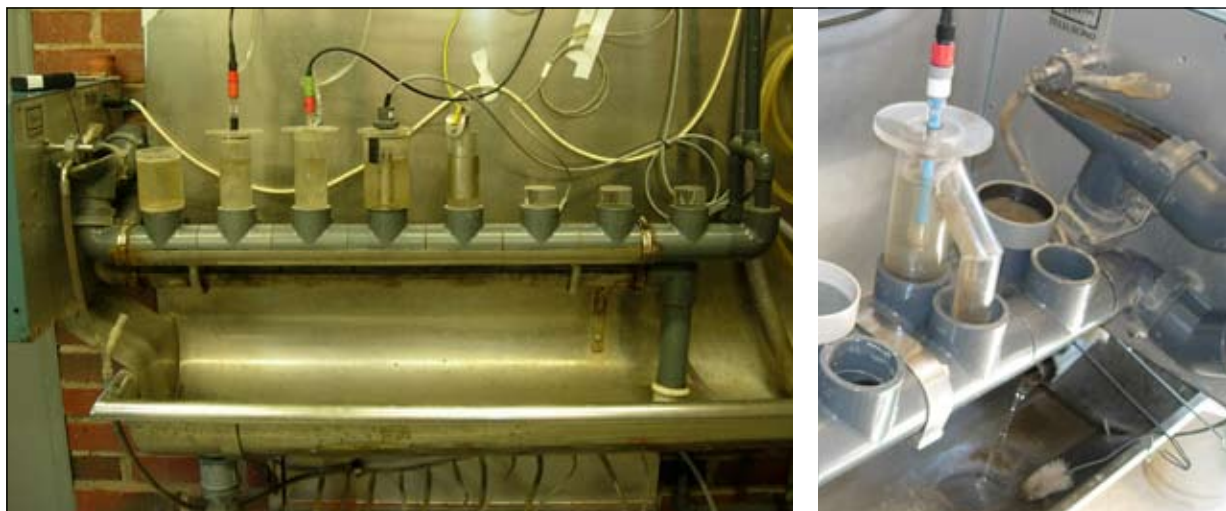
Figur 8-1 Uppställning för övervakningen av pH, konduktivitet, redoxpotential, temperatur och turbiditet (Foto A. Hedström)
