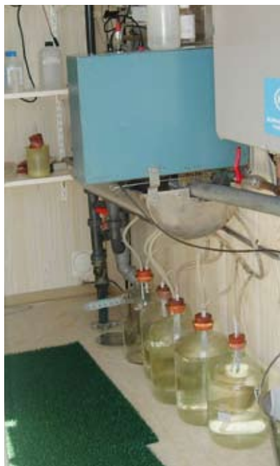
Figur 8-2 Övervakningsstation med glasflaskor för automatisk vattenprovtagning i förgrunden (Foto: A. Hedström)
