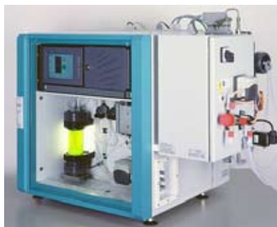
Figur 9-1 Daphnia Toximeter (BBE-moldaenke)
