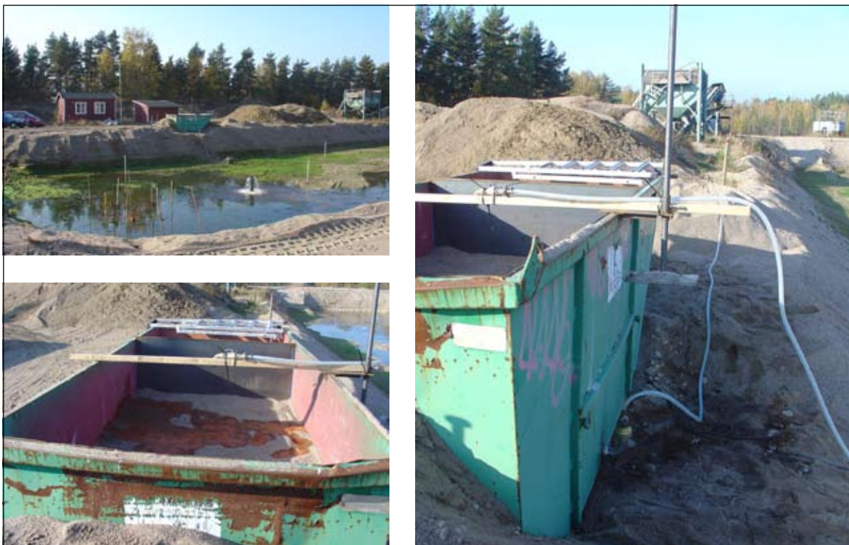
Figur 8 Containerförsöket. Bilden till vänster visar hur filteret vattenmättades underifrån för att undvika luftinstängning.
