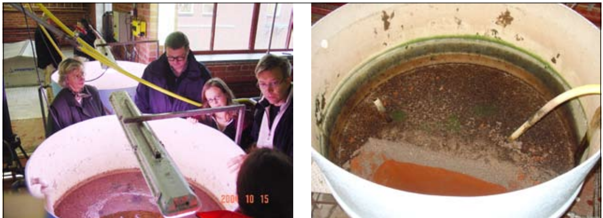
Figur 3 Bilden till vänster visar referenskolonnen med biohud. Notera lampan med det artificiella solljuset. Bilden till höger är från sandprovtagningen i IOCO-kolonnen som gjordes efter det att försöket avslutats. Gränsen mellan den ovanlagrade filtersanden och IOCO-skiktet är mycket skarp.
