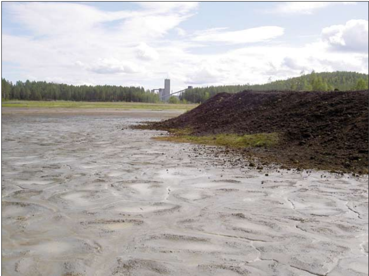
Röttslam utlagt på anrikningssandsmagasinet Gillervattnet, Boliden. På bilden syns kanten av en försöksruta som består av tre lager täckmaterial: röttslam, flygaska och röttslam (s.k. "sandwich"-modell). Anrikningsverket syns i bakgrunden. Foto: Clara Neuschütz
