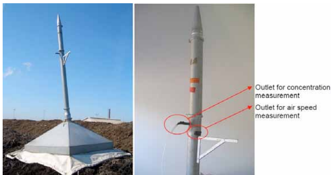
Figur 12. Provtagningshuv vidareutvecklad av Rambøll och DTU. (14)
