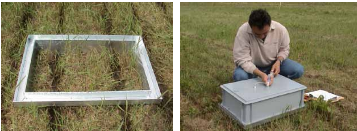
Figur 1. Sluten kammare. Ram med vattenlås till vänster placerad över två gödselsträngar utspridd i vall, provtagning vid förslutning till höger. (7)
