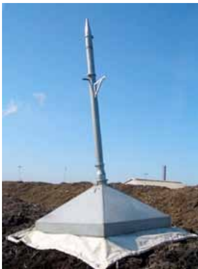
Figur 5. Provtagningshuv använd vid mätningar på kompost i Danmark (14)
