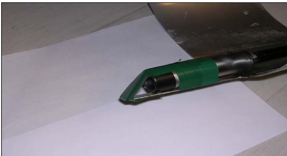
Figur 3–3. Nivågivarens membran kan skyddas med hjälp av tejp
