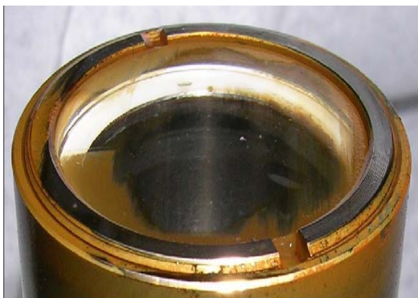
Figur 11.1. Vanskelig fjernbar beleggdannelse på uheldig utformet (nedfelt) sensorvindu (Roaldset. 2008)
