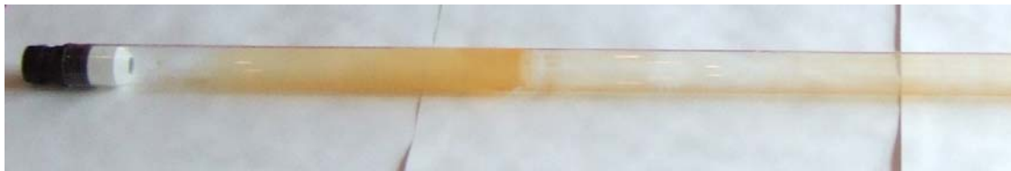
Figur 4.8. Beleggdannelse på kvartsrør (A. Seim, 2008)
