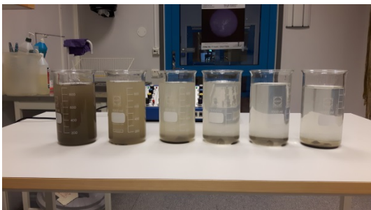
Figur 8: Kemisk fällning och sedimentering av urban smältvattenmix. Notera synlig turbiditetsförändring.
