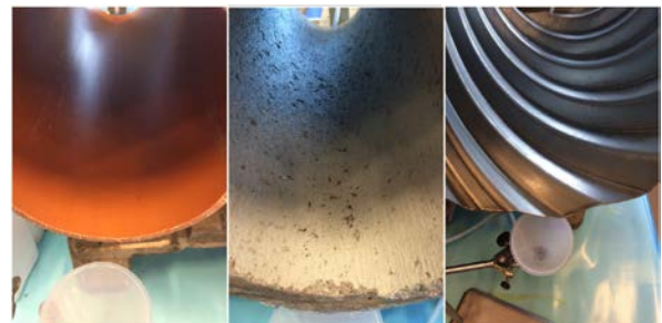
Figur 6. Försöksuppställning för tester av hur olika ledningsmaterial påverkar transporten av föroreningar.
