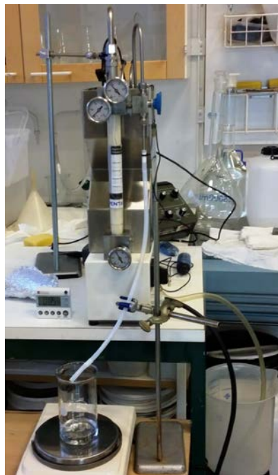
Figur 11. Utrustning för nanofiltrering av snösmältvatten.
