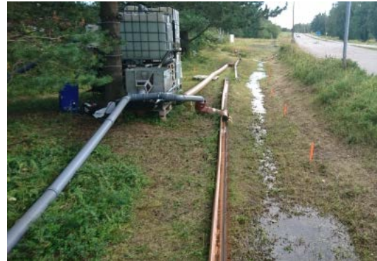
Figur 14: System för vattentillförsel och mätning för svackdike (matningsrör för både punktbevattning och lateral bevattning).
