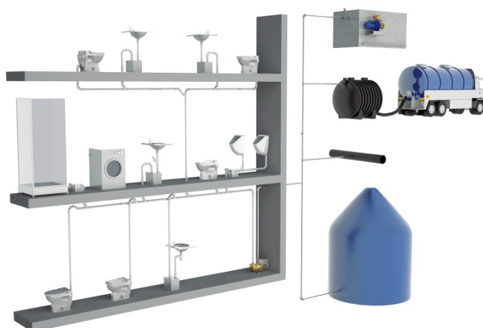
Figur 5 - Förslag på insamlingspunkter och transportmål för vakuumsystem. Bild med tillåtelse av Jets Vacuum.
