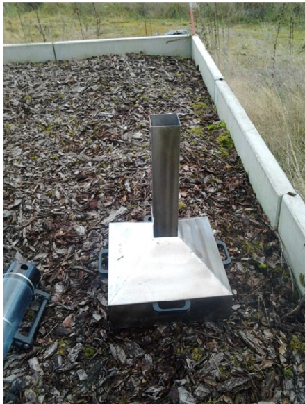
Figur 5-2 Provtagning på ventilerad yta (biofilter)
