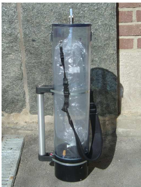
Figur 5-1 Vacuumprovtagare med inbyggd pump
