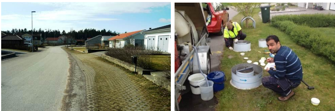
Figur 12. Studier av permeabla ytor i Växjö. Till vänster: villagata med permeabel sidosektion. Till höger: montage av dubbelring-infiltrrometer.
