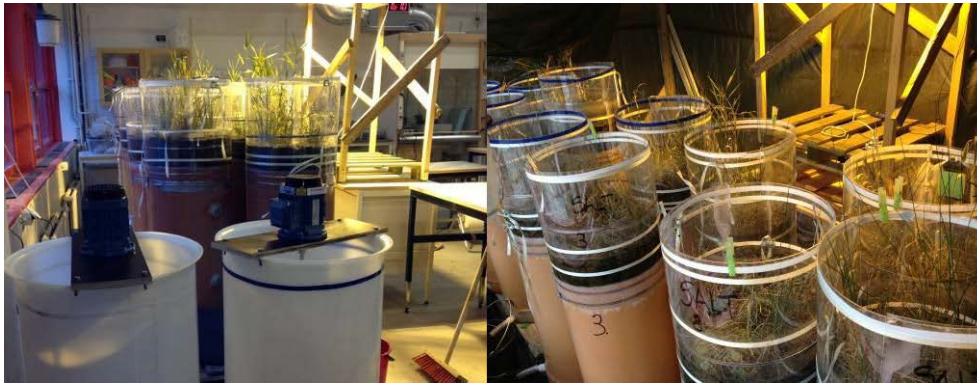
Figur 7. Labbförsök med biofilterkolonner vid LTU
