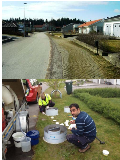
Figur 9. Studier av permeabla ytor i Växjö. Övre bild visar villagata med permeabel sido-sektion, nedre montage av dubbelring-infiltrrometer.
