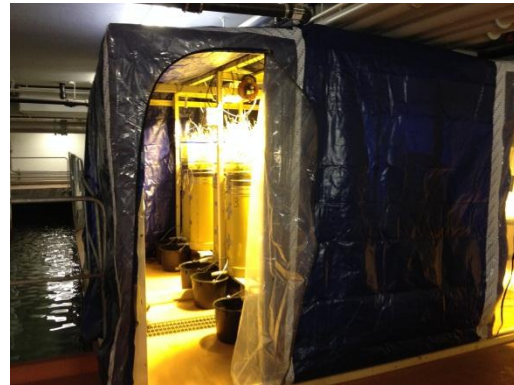
Figur 6. Labbförsök med biofilterkolonner
