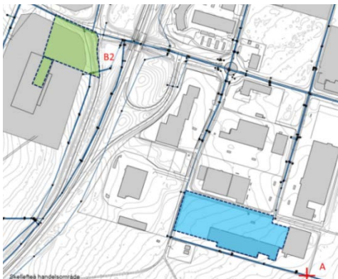
Figur 11: Solbackens handelsområde, Skellefteå. Blåfärgat område har konventionellt dagvattensystem med dagvattenavledning i rör, grönfärgat har alternativ dagvattenlösning med öppna diken och infiltrationsteknik.
