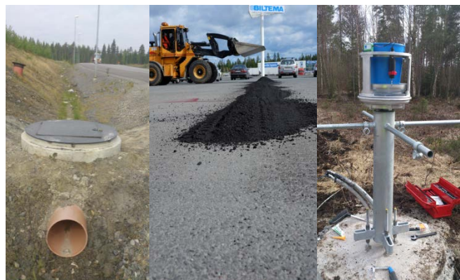
Figur 12: Flödesmätning i utlopp från dagvattendike/swale (vänster bild), Invallning av avrinningsyta för LID-yta (mitt bild), Nederbördsrätmätare Geonor T200b – mäter direkt både regn och snö (höger bild)
