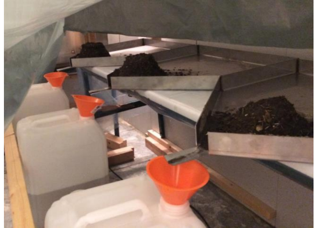
Figur 9: Snösmältningsexperimentet i klimatrums (LTU) anpassat för analys av mikro-skräp.
