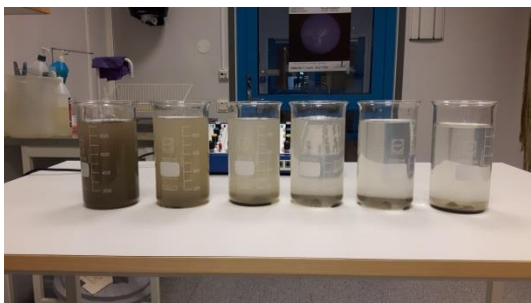
Figur 7: Kemisk fällning och sedimentering av urban smältvattenmix. Notera synlig turbiditetsförändring.
