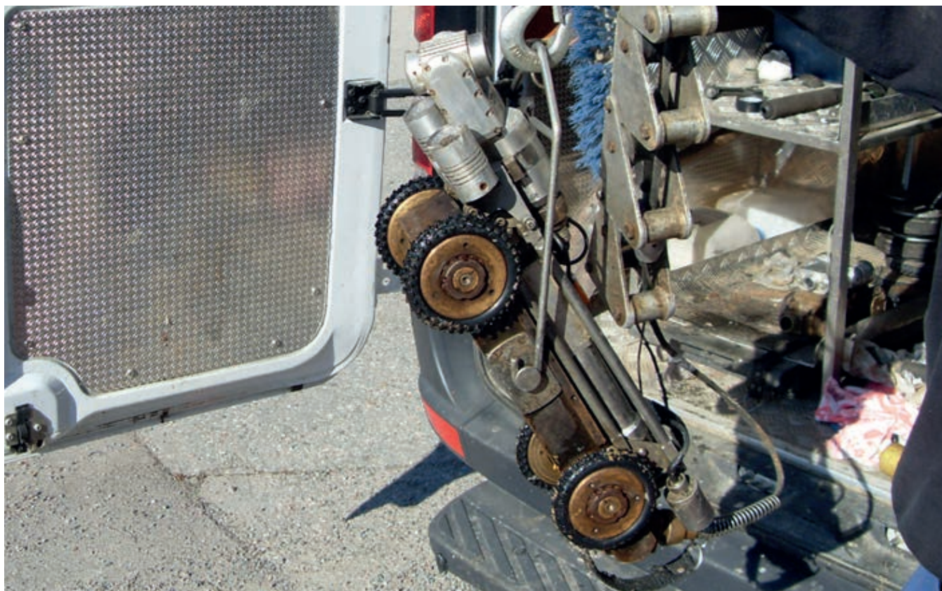
Kameravagn för TV-inspektion av ledningsnät
