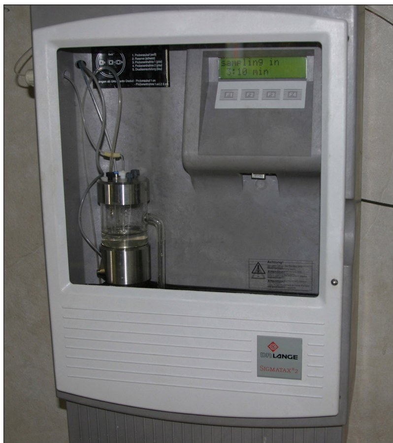
Figur 5-3. Kontinuerlig mätare för mätning av totalfosfor och fosfatfosfor. Mätningen skedde efter biosedimenteringen.
