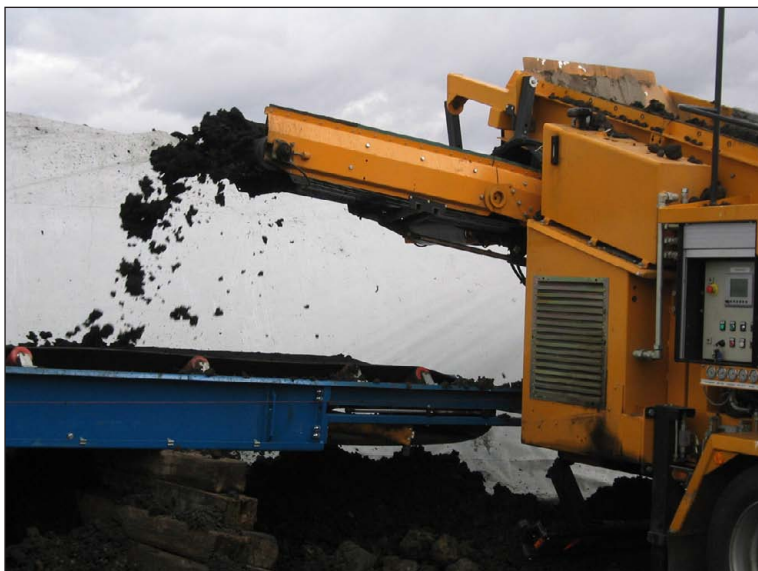
Figur C1-2. Utmatning av slam från stjärnsikten till transportbandet.
