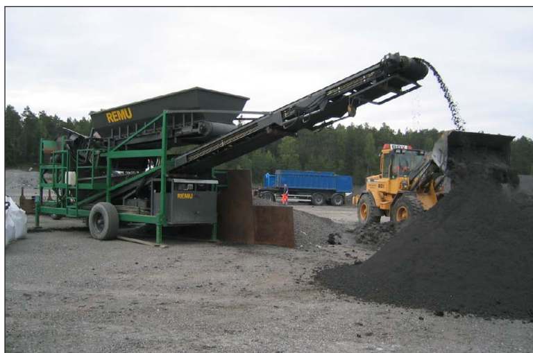
Figur C2-2. Blandning av aska och slam i stjärnsikt vid SRV återvinning.
