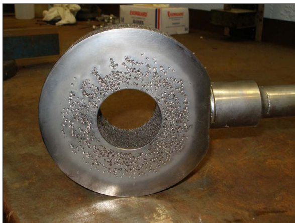
Figur 5-1. Ett s.k. horn som är påverkat av kavitation. (Foto Maria Dåverhög).
