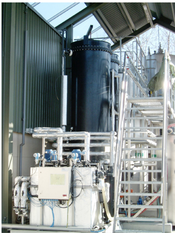
Figur 5-4 Foto UASB-reaktorer med mixertanken i förgrunden. Foto Frida Hesselgren.
