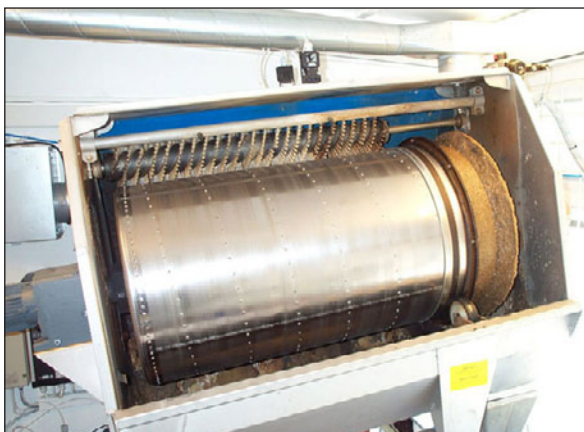
Figur 8.4 Bild på sil med öppen framlucka.
