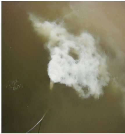
Figur 3-3 Kalkvattenberedning och inblandningspunkt i Bredbyns fällningsdamm, Örnsköldsvik.
