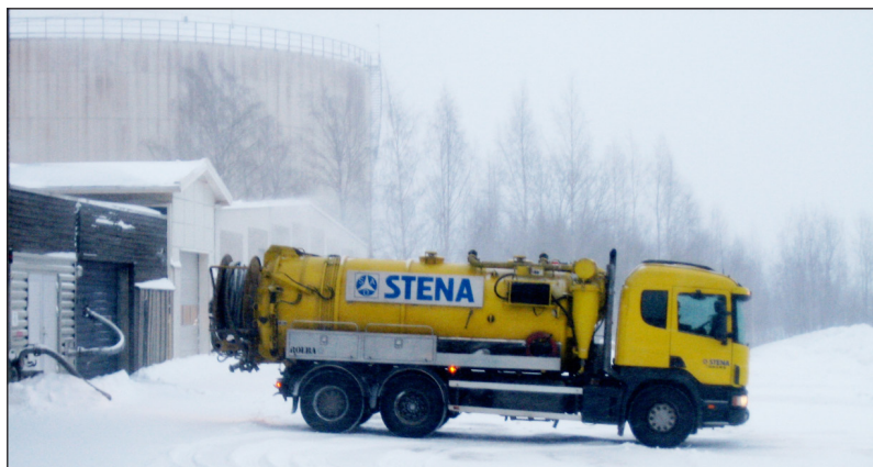
Figur 7-6 Fettslammottagning vid Uddebo reningsverk, Luleå. (Foto: G. Blecken)
