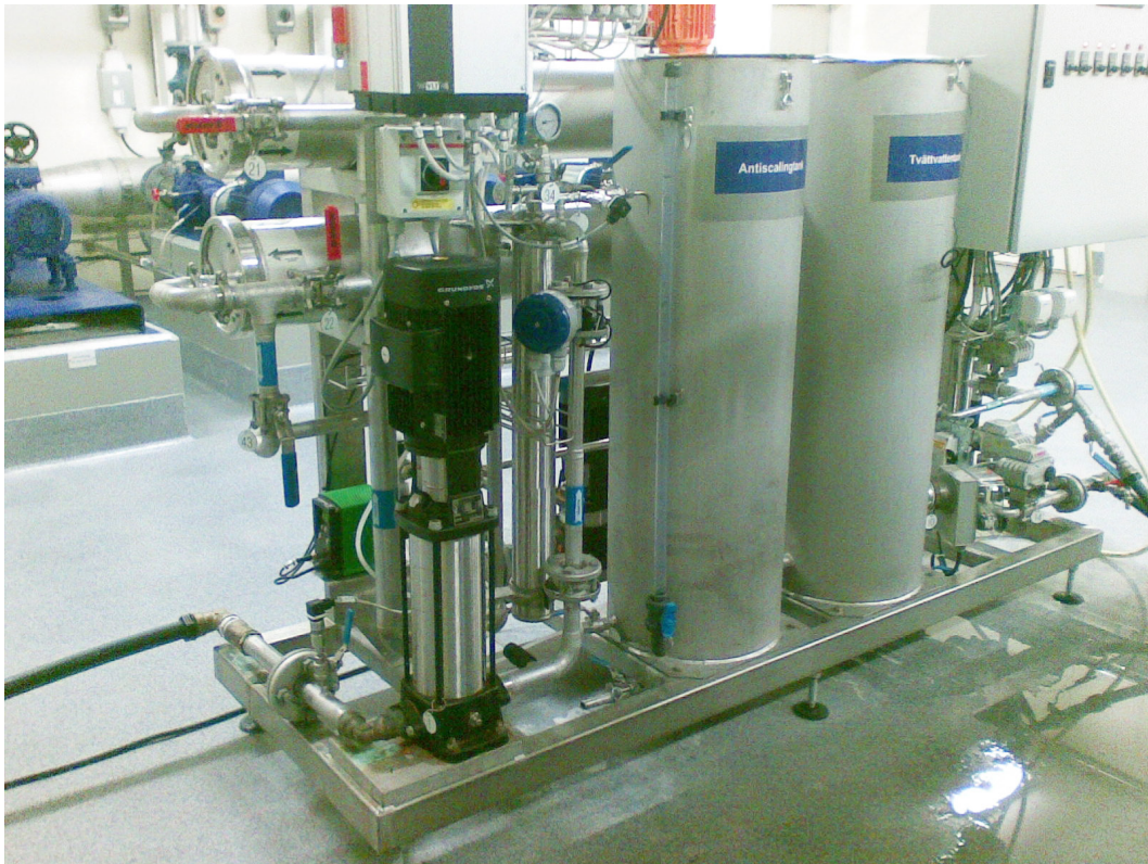
Bild E-3 Nanomembranpilotanläggning med automatiskåp, permeatutlopp och koncentratutlopp.
