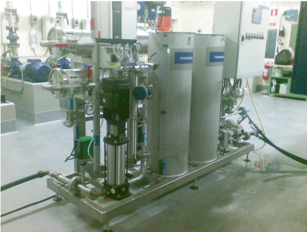
Bild E-1 Nanomembranpilotanläggning med råvatteninlopp, tryckstegringspump, doseringspump för antikoagulationsämne, tvättvattentankar, permeatutlopp och koncentratutlopp.
