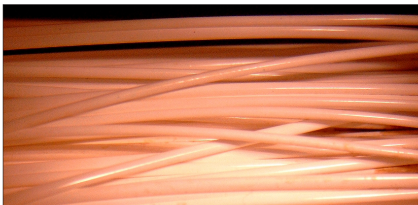
Figur 2-2 Ultrafilter-hålfibrer (Foto: Gerald Heinicke).
