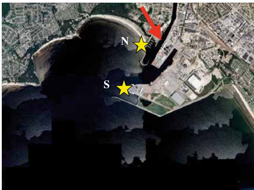
Figur 11-1 Avloppsreningsverkets utsläppspunkt är markerad med en röd pil och kontrollpunkterna där resultat från olika simuleringar hämtats är markerade med gula stjärnor (N = nord, S = syd).
