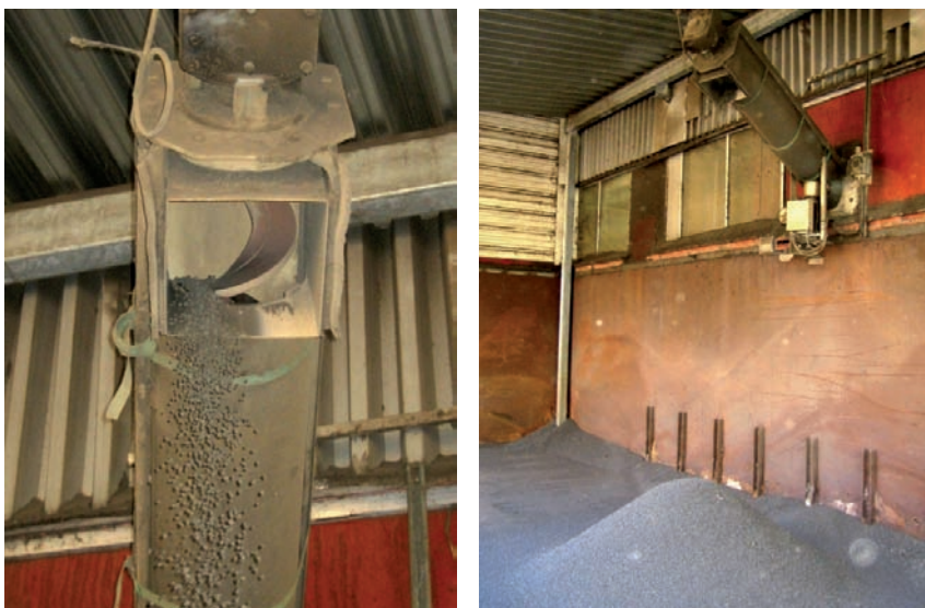
Figur 3-6 Utmatning av färdiga UF-berikade slamgranuler.
