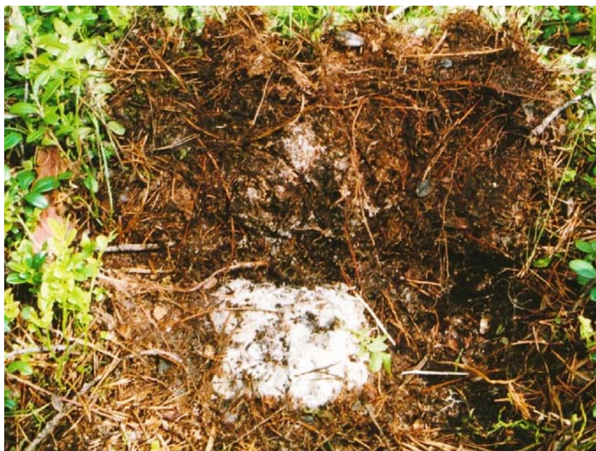
Figur 3-10 Nätpåsar med slamgranuler, begravda i humustäcket. Den uppfläktade rotmattan och vegetationen återställdes så att påsarna var fullständigt täckta.
