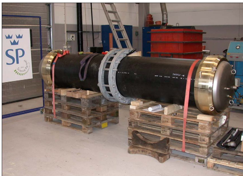
Figur 4-1 Bild av försökuppställningen med ändbeslag och flänsförbandet i mitten.
