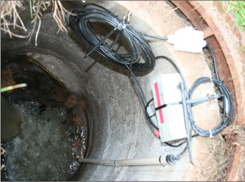
Figur 5.3 Exempel på registrering av bräddning genom nivåregistrering i bräddpunkt och dataöverföring via GPRS.
