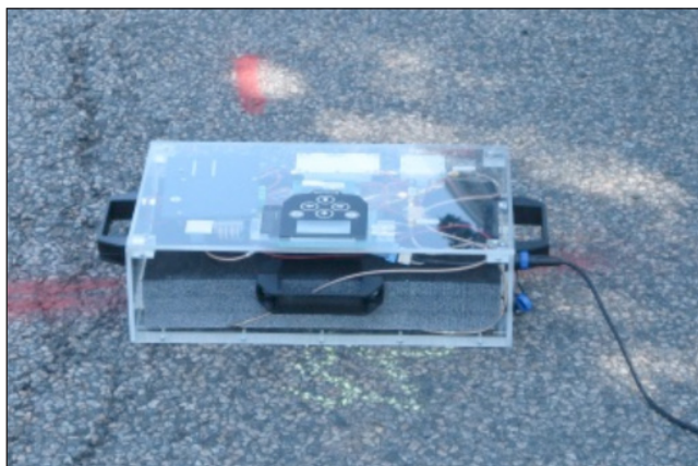
Figur 4.3.1 Dopplerradar för registrering av vattenrörelser i asfalterad gata.
