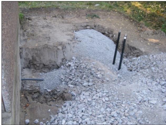
Figur 4.2.2 Läckor i grus respektive asfalterad väg, djup 1,1 m och 1,6 m, läckdiameter 40 mm.
