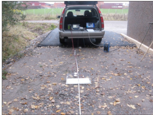
Figur 4.2.2 Läckor i grus respektive asfalterad väg, djup 1,1 m och 1,6 m, läckdiameter 40 mm.
