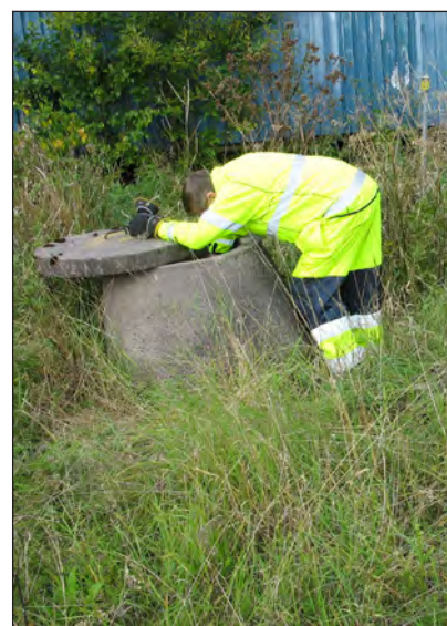
Figur 3-1 Provtagning i spillvattenbrunn
