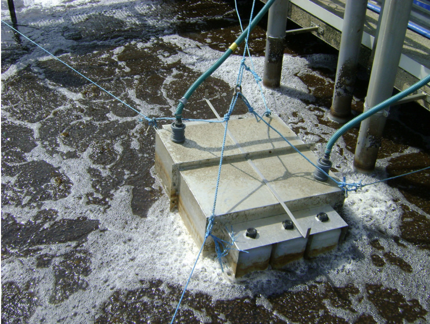
Figur 3-1 Exempel på huv för lustgasanalys. Bild från IVL Svenska Miljöinstitutet.
