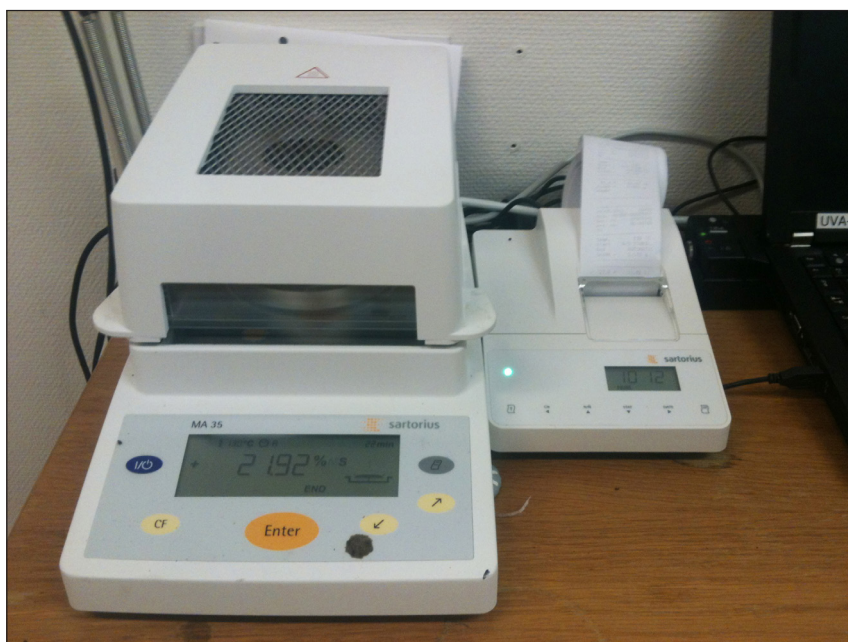
Figur 3-4 TS-våg Sartorius MA-35. Foto: Magnus Philipson SLU.
