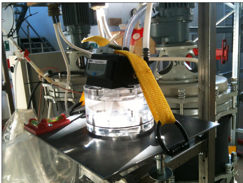
Figur 3-5 Gasmätare Ritter MGC-1 v3.0. Foto: Magnus Philipson SLU.
