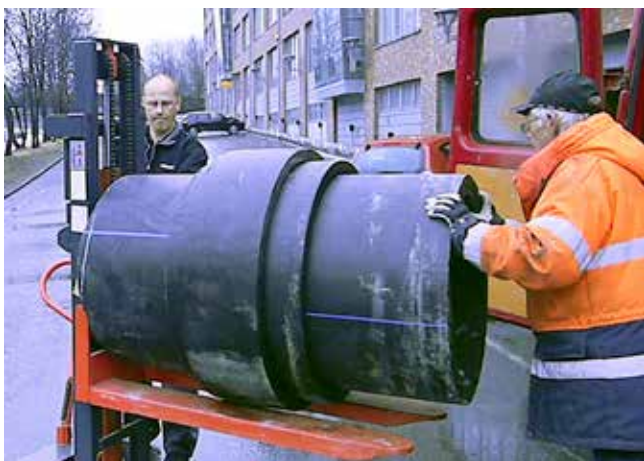
Figur 3.3.7 DN710 muff från Norrvattens Norrtäljeledningsprojekt som anlänt hos Inspecta Sweden AB för att inspekteras med digitalröntgning.
