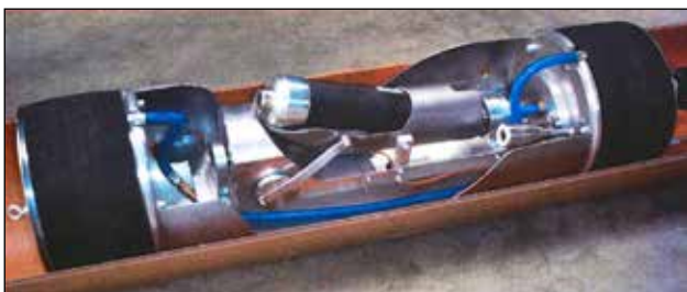
Figur 3.4.4.1 Exempel på anordning med uppblåsbara pluggar som finns i dimensionerna DN250–800 för huvudkanalen och med plugg för sidokanal i dimensionerna DN100–150. Den är förberedd för anslutning till en provtryckningsutrustning och är försedd med kamera. Anordningen kan monteras på en speciell vagn för att lätt kunna förflyttas i en ledning.
