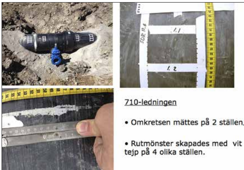
Figur 3.3.1 Bilder tagna i gropen där svällningsmätningarna skulle göras i samband med provtryckningen av DN710-ledningen. Omkrets-förändringen mättes dels med måttband dels genom fotografering av ett pålagt rutmönster.
