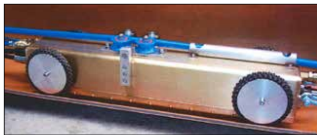
Figur 3.4.4.1 Exempel på anordning med uppblåsbara pluggar som finns i dimensionerna DN250–800 för huvudkanalen och med plugg för sidokanal i dimensionerna DN100–150. Den är förberedd för anslutning till en provtryckningsutrustning och är försedd med kamera. Anordningen kan monteras på en speciell vagn för att lätt kunna förflyttas i en ledning.
