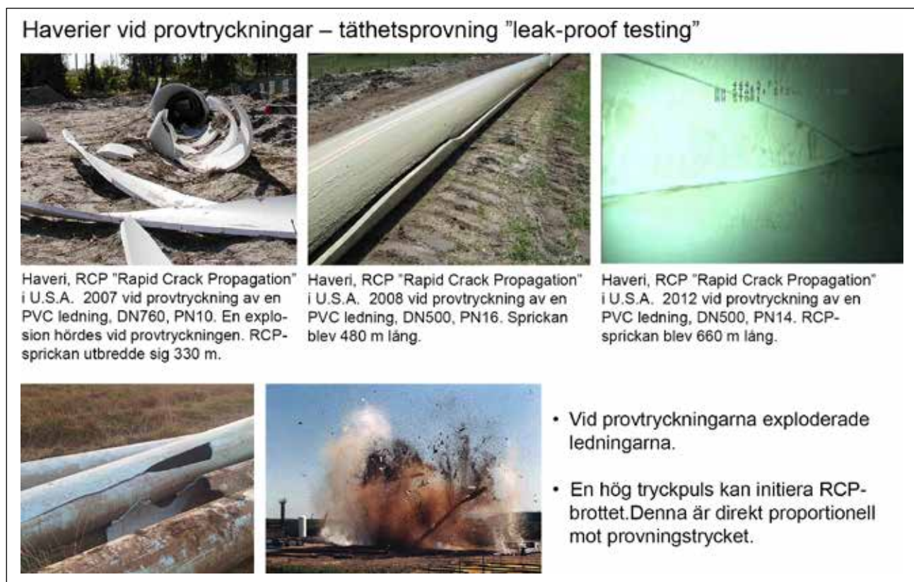
Figur 3.1.1 Några fall av RCP-brott som inträffat på senare tid vid provtryckning av grova PVC-vattenledningar i U.S.A. Ledningsdelarna som provtrycktes blev totalt förstörda. Sprickorna i respektive fall varierade i längd mellan 330 m och 660 m (3).
