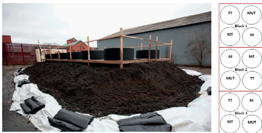
Figur 4.2 Pilotanläggning med 12 behållare för mätning av växthusgas-emissioner från lagring av rötat avloppsslam, Kungsängens gård, Uppsala. Till höger visas de 12 behållarnas placering och försökets blockindelning.
