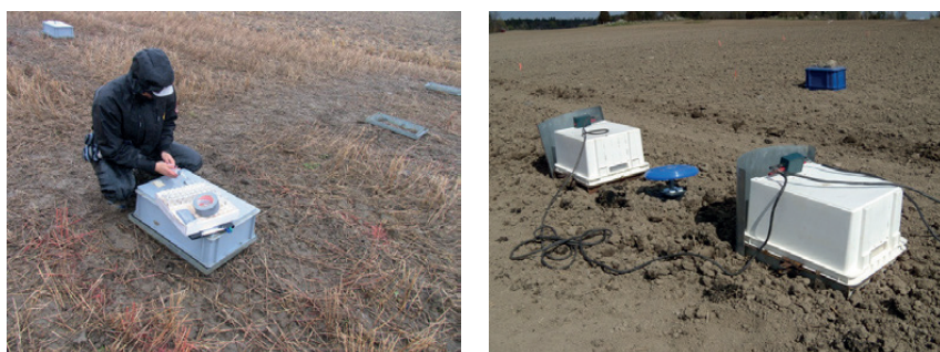
Figur 5.4 Mätning av lustgas och metan med slutna kamrar (höst), tre per ruta i varje block (vänster). Pågående mätning av ammoniak efter vårspridning (höger).
