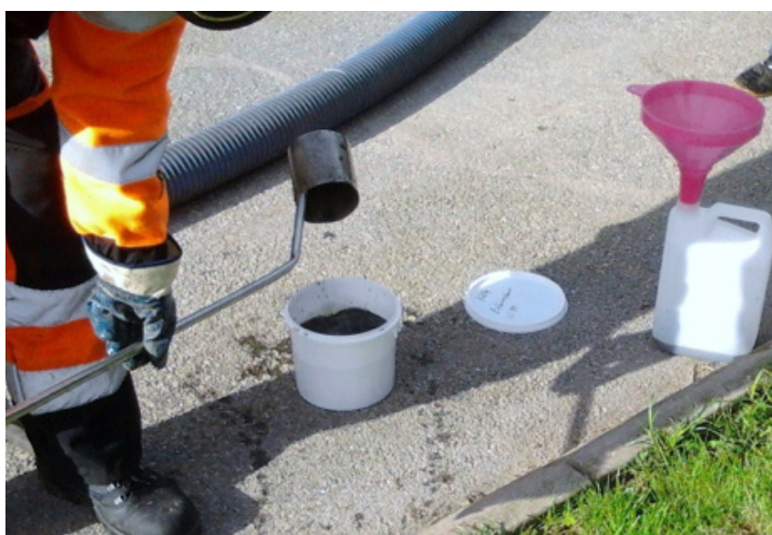
Figur 2.1 Klosettavattenprovtagning vid Källby reningsverk i Lund. Foto: Jan Erik Mattsson
