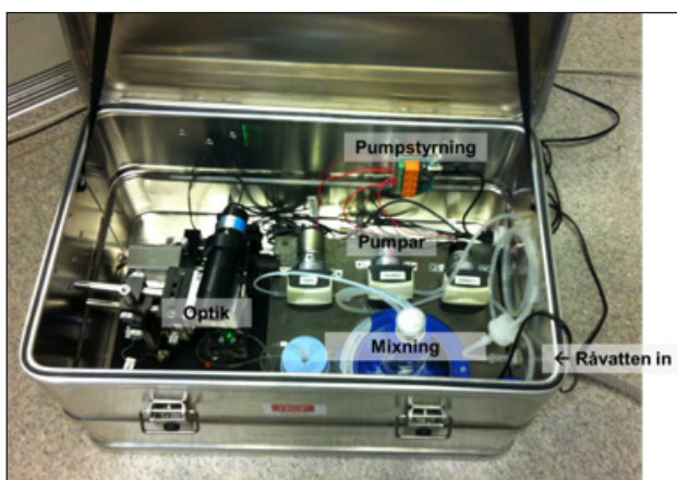
Figur 3.5 Det integrerade instrumentet anpassat för fältbruk innehållande bland annat optik för detektion av fluorescerande signalen, fluidik och elektronik för pumpstyrning och mixning. Mätningen styrs via en laptop kopplad till instrumentet via USB.
