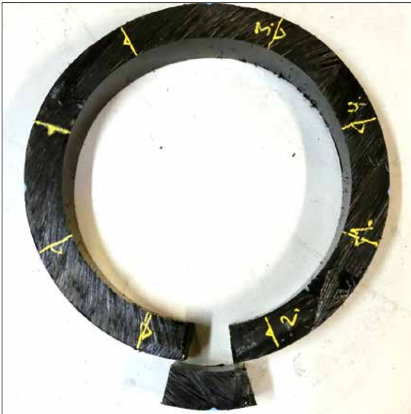
Figur 4-4 Vid uppslitsning av ringen minskar diametern beroende på inre dragspänningar i innerskiktet.
