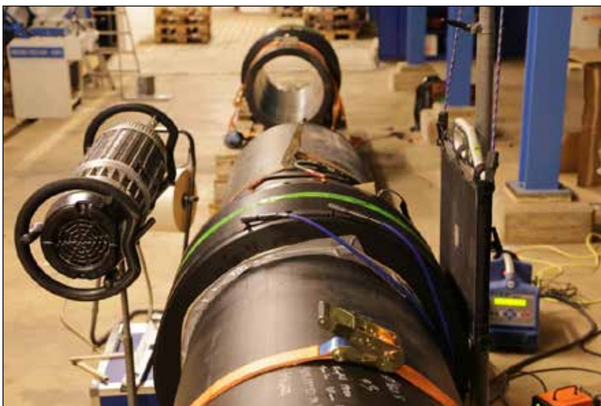
Figur 4-3 Röntgenutrustning, uppställd för att ta bilder i överkant av röret och muffen. Strålkällan visas till vänster om röret och detektorn till höger.
