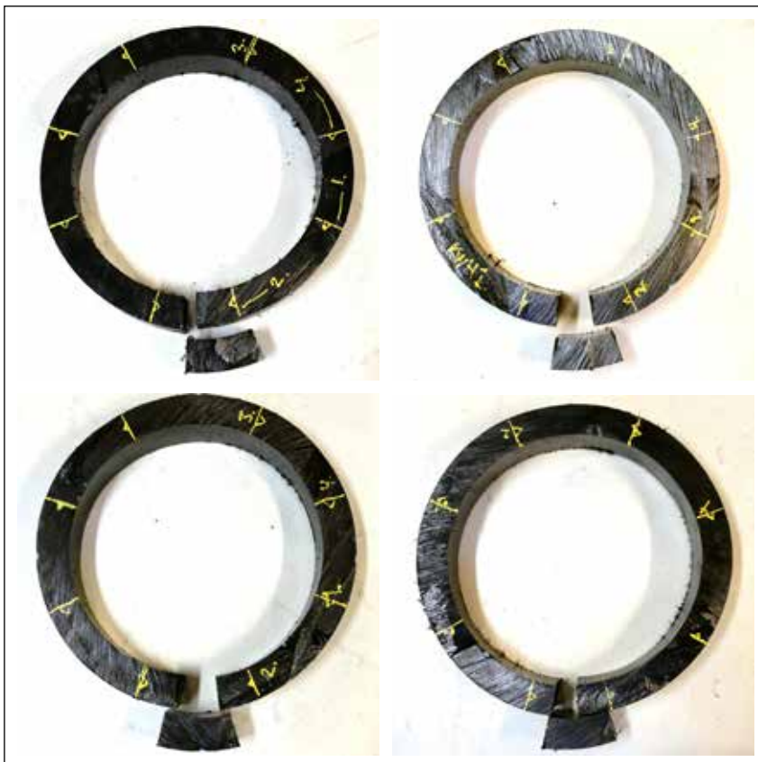
Figur 4-8 Uppslitsade rörbitar, ca 100 timmar efter kapning. Uppe till vänster: prov 1 Hallingplast, uppe till höger: prov 2 KWH:1, nere till vänster prov 2 KWH:2, nere till höger prov 3 Uponor.
