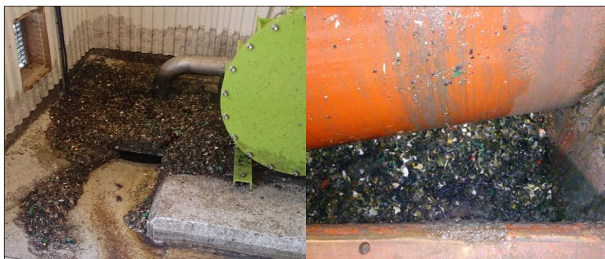
Figur 3-2 Bild till höger: Plastrester har ansamlats ovanför rejektvattenbrunnen. Bild till vänster: Plast i DC10 centrifugen.
