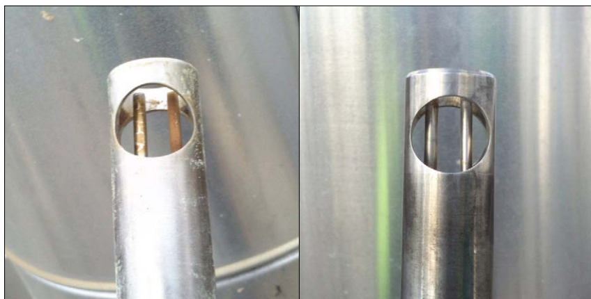
Figur B-2 Vänster: Termisk givare före rengöring. Höger: Termisk givare efter rengöring.
