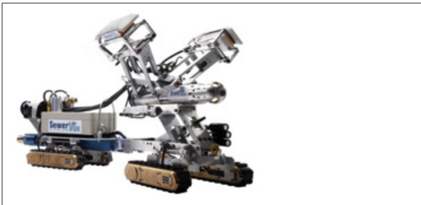
Figur 4.6 Robot som kan inspektera icke-metalliska ledningar som betong och plastledningar inifrån ledningen. Radar utgör en del av lösningen då radarn fångar upp godstjocklek och slitningar [27].
