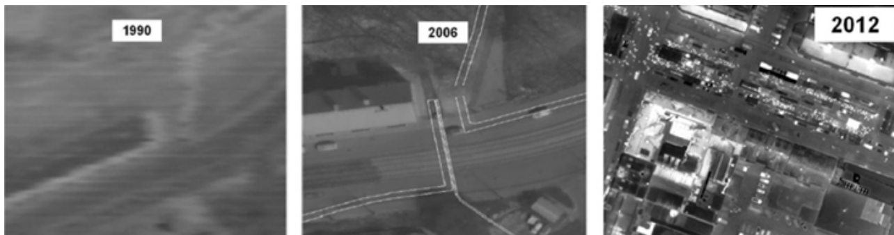
Figur 6.2 Bildserie som uppvisar utvecklingen med flygtermografering. De två första bilderna är från 1990 och 2006 och är tagen från samma position med en höjd på 600–800 m. Den sista bilden från 2012 är tagen från 800m höjd över torget i Örebro och där kan man tydligt se individer [37].
