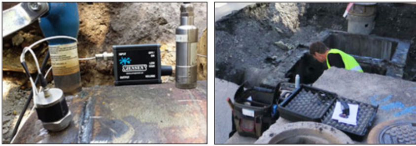
Figur 2.4 Jensen AB arbetar med metoden i Sverige och kallar den för Delta-t. Metoden är smidig att använda då den varken kräver avbrott i drift eller uppgrävning utan endast åtkomst till ventiler [8].
