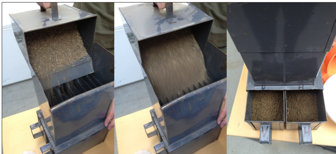
Figur 1-1 Provdelare som använts för att ta ut delprov till vattengenomsläpplighetsmätningen. När provet hålls i provdelaren fördelas det via spalter till två lådor. Provet halveras därmed varje gång provdelaren används.
