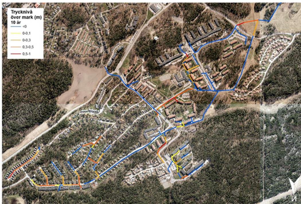
Figur 1-2 Exempel på hur resultatet i form av trycknivå från hydraulisk modellering kan visas i plan.
