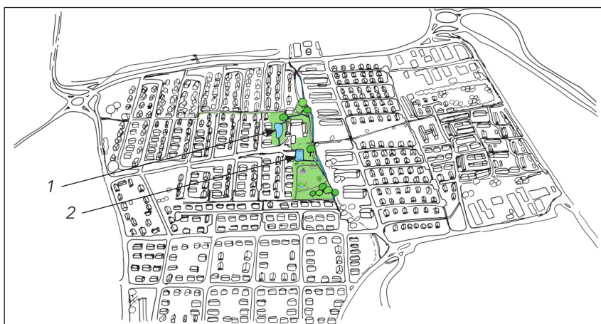
Figur 18-4 Konceptskiss för alternativ 2. Torra dammar är markerade i blått och numrerade 1-2.
