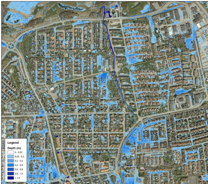
Figur 18-3 Vattendjup i instängda områden. Streckade markeringar visar lågpunkter där mycket vatten riskerar att ansamlas.
