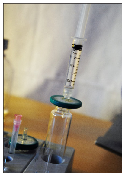
Figur 2-2 Enzymsubstrat spolas genom filtret.
