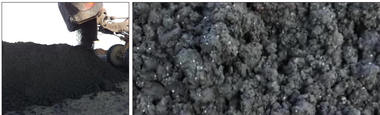
Figur 7-1 Inblandning av urea och uppläggning av slamsträngarna (ca 65 ton) med blandarskopa (vänster) och den resulterande inblandningen av 1,6 % urea relativt våtvikt (höger) (Foto: Annika Nordin)
