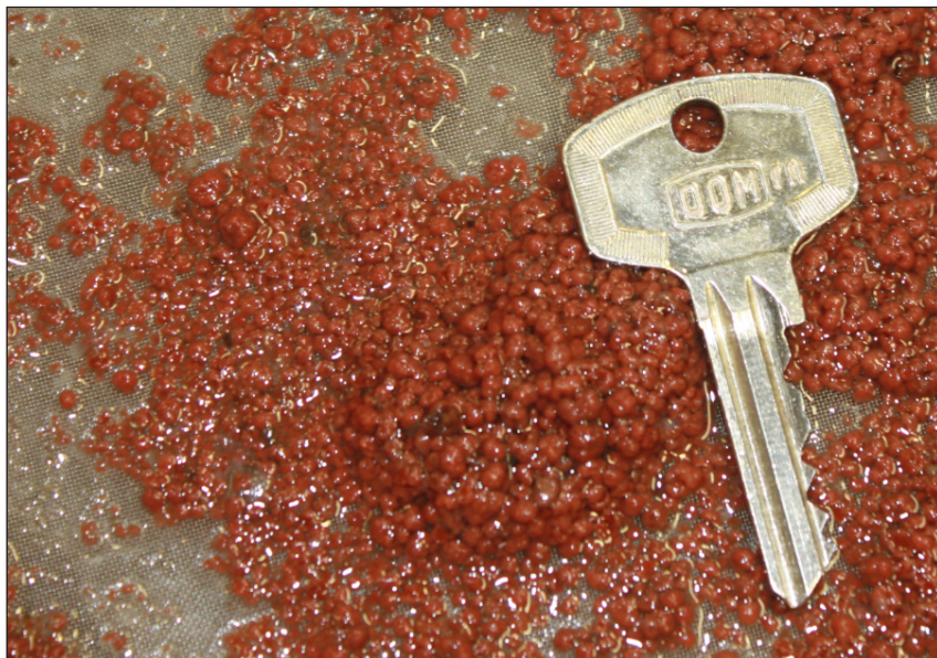
Figur 8-10 Granuler vid ANAMMOX®-anläggningen i Olburgen.
