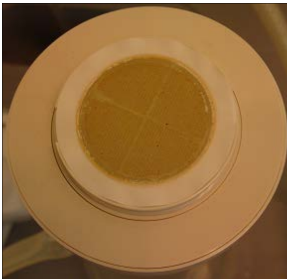
Figur 7-1. 0.45 µm cellulosafilter efter att kemiskt fällt vatten har filtrerats
