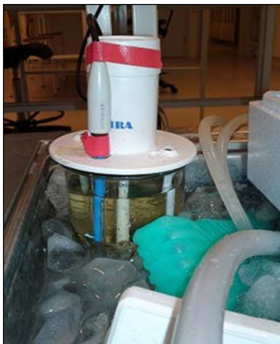
Figur 6-2. Provbägare, omrörare och pH-mätare i vattenbadet
