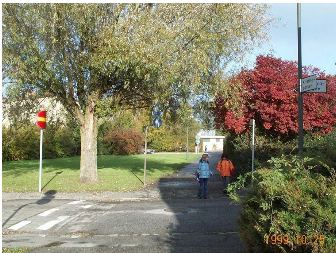
Fig. 18. Vitpilar markerar korsningar mellan gång- och cykelväg samt villagatorna i kvarteret. Avloppsledningar ligger placerade i gång- och cykelvägens mitt. Avståndet mellan träd och ledningar avslöjas bl.a. av brunnslockets placering i förhållande till trädet.
