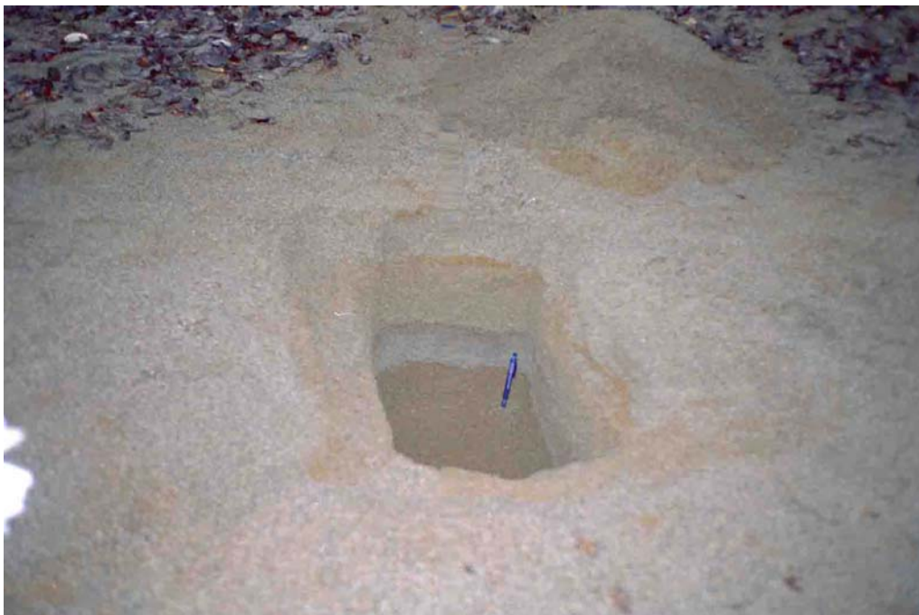
Skiktning i infiltrationsbädd. Den mörka linjen är järn och mangan som fällts ut i gränsskiktet mellan filtersanden och kalklagret.
